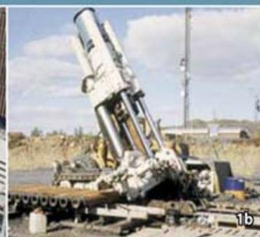
Foto 1b – Perfuratriz Raise Borer para poço inclinado na mina de cobre – Bolívia, 1986
