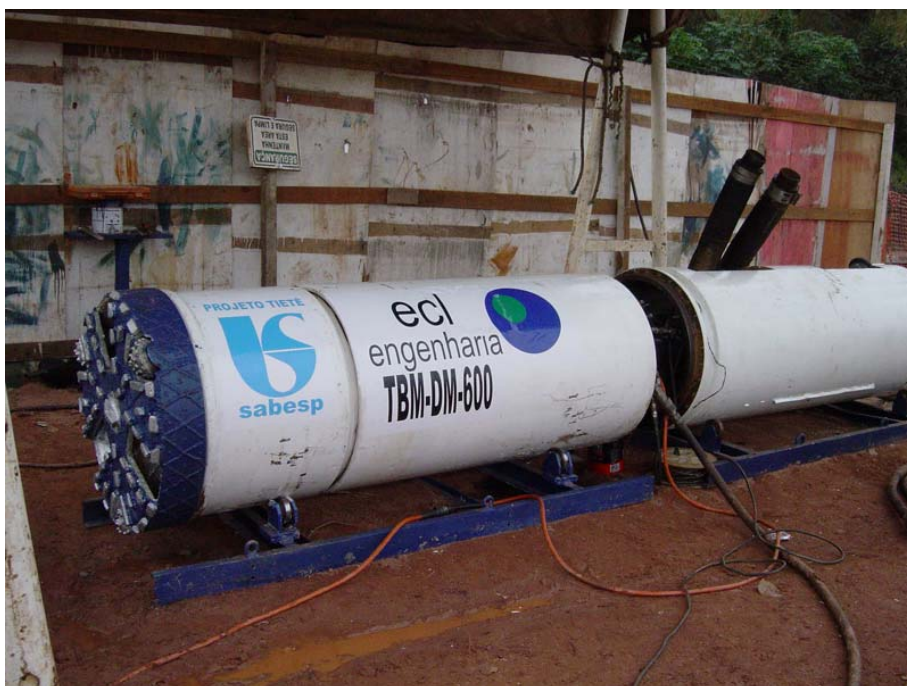
Foto 1 – Exemplo de Slurry Shield Misto (Solo e Rocha) para execução de coletor tronco de esgoto por Pipe Jacking
