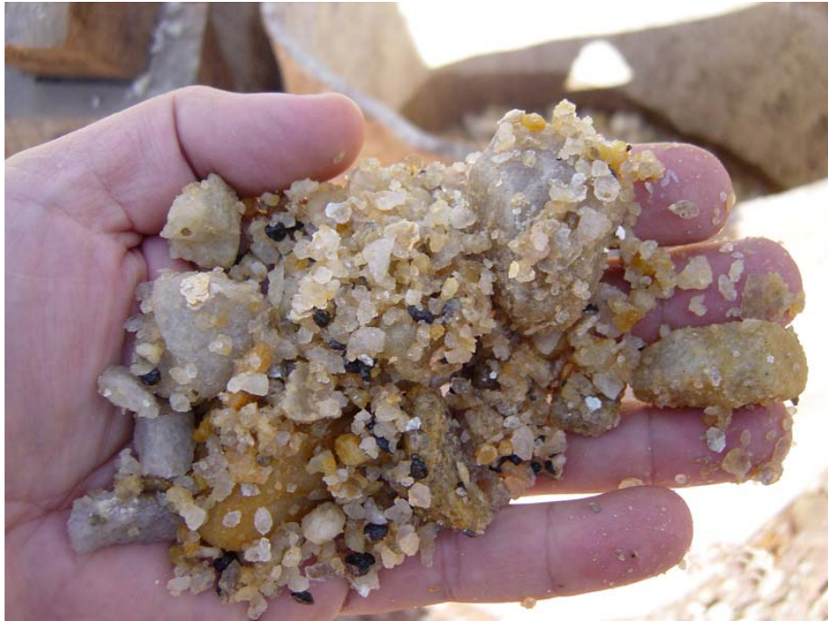
Foto 17 - Granulometria Típica (notar variabilidade do tamanho de grãos) de Material Escavado com Slurry Shield Misto, em obra de Coletor Tronco
