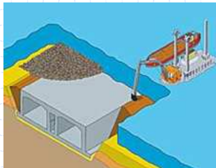
Figura 10 – Preenchimento lateral e sobre o túnel (Tribune,1999)
