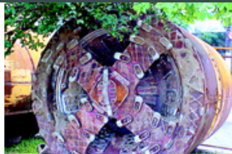
Shield EPB para execução de tubos cravados, detalhe de visão de corte
