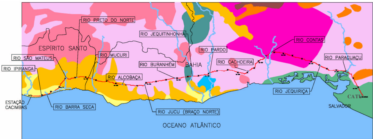
Figura 2 - GASCAC - Gasene (Gasoduto do Nordeste) :Estudos Geológicos Geotécnicos e Definição de 14 Travessias Subaquáticas em Perfuração Direcional no Trecho Cacimbas – Catu
